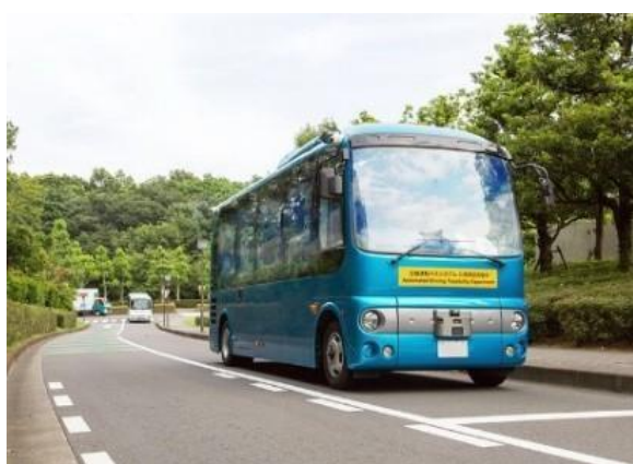
日野自動車㈱の「日野ポンチョ」をベース に改造した自動運転バス 出典：大阪市高速電気軌道（大阪メトロ） 大阪シティバス㈱
