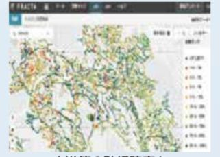
水道管の破損確率を地図上で色分け表示
