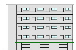
比較的幅の狭い庇の見付面等
