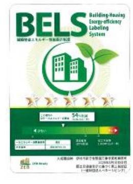
作業所事務所 BELS での ZEB Ready 認証取得
