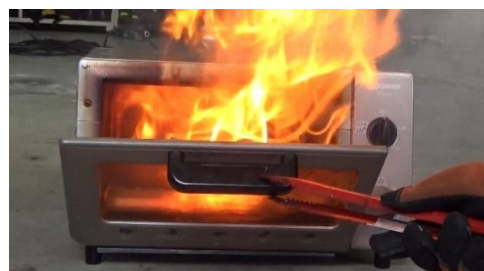
発火後、扉を開けた様子
